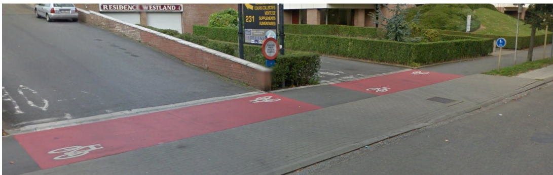
Illustration 16: coloration rouge + figurines vélos au droit de chaque entrée riveraine, débouché de parking
