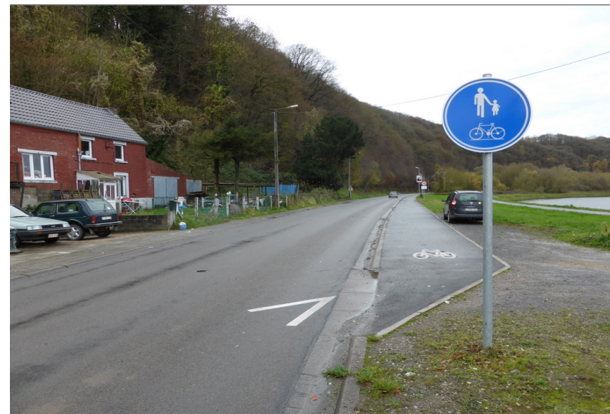
Illustration 2: Mise en place d'un D10
